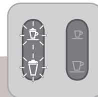
洗浄を開始します。ミルクレシピボタンが約12秒間点滅します。
