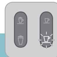
Lungo ボタンが点滅するまで待ちます。残りの湯垢洗浄を続けます。
