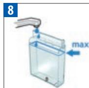
水タンクを取り外し、じゅうぶん水道水ですすいでください。max の線まで水道水を注ぎコーヒーメーカーにセットしてから 5 のように1リットル以上の容器を2種類のノズルの下においてください。
