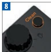
ミルクレシピを使用された後は必ずカプチーノノズル洗浄ボタンを10秒以上押して、高速カプチーノシステムを洗浄してください。(ミルクレシピ抽出後5分以上放置しないでください。故障の原因になります)
