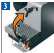
湯垢洗浄用パイプ収納部のふたを手前に引いて開け、湯垢洗浄用パイプを取り出し、蒸気パイプスライドカバーを開けてノズルが下を向くように取り付けてください。
