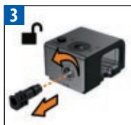
カプチーノ泡立て機構部分背面の接続部を反時計方向に回して抜き取ります。
