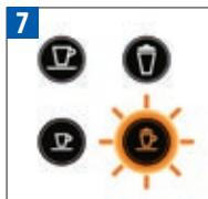
水タンクの中の湯垢洗浄溶液が無くなるとカプチーノボタンが点滅します。
