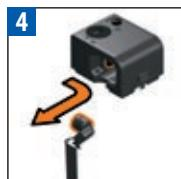
カプチーノノズルを抽出ポジションに上げ、前側にずらすようにして抜き取ります。
