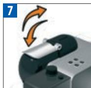
抽出が完了したら、まずカップをコーヒーメーカーからおろしてください。次に開閉レバーを上下させて使用済みカプセルをカプセルコンテナに落としてください。
