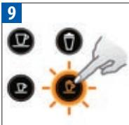
カプチーノボタンを再度押します。すすぎ行程が始まりコーヒー抽出口、湯垢洗浄用パイプ、ドリップトレーに自動的に切り替わりながらすすぎ湯を排水します。すすぎ中はカプチーノとラテマッキヤートボタンが交互に点滅します。
