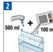
ドリップトレイと使用済みカプセルコンテナを空にしてコーヒーメーカー本体にセットしてください。水タンクに 500ml の水を入れ、100ml のネスプレッソ純正の湯垢洗浄剤を注いでください。
