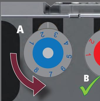
重複該程序，設定左側的冷牛奶泡沫設定控件 (A)。
