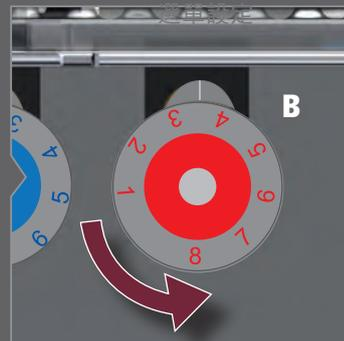
右轉設定控件 (B)，直到看到氣泡。然後小幅度反方向轉設定控件。
