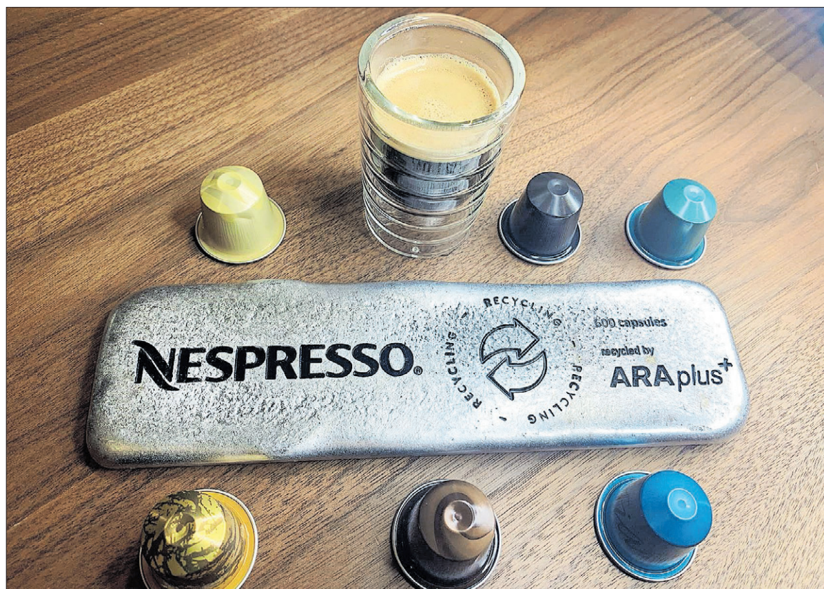
Ein Barren aus Aluminium gepresst: Das Ergebnis aus 600 Nespressokapseln. Ziel ist, daraus wieder 600 neue Kapseln zu produzieren.
